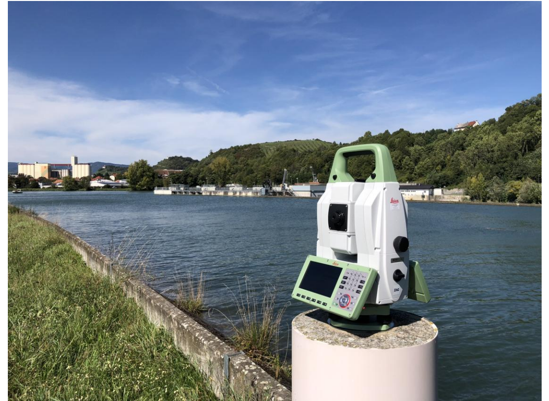
Meritve prelivnega in opornega zidu pri pregradi Melje
