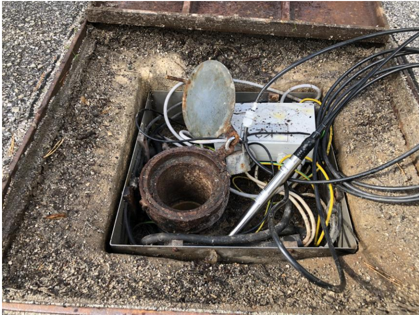
Vrtina, opremljena z avtomatskim merilcem piezometričnega tlaka (SEL, pregrada Završnica)
