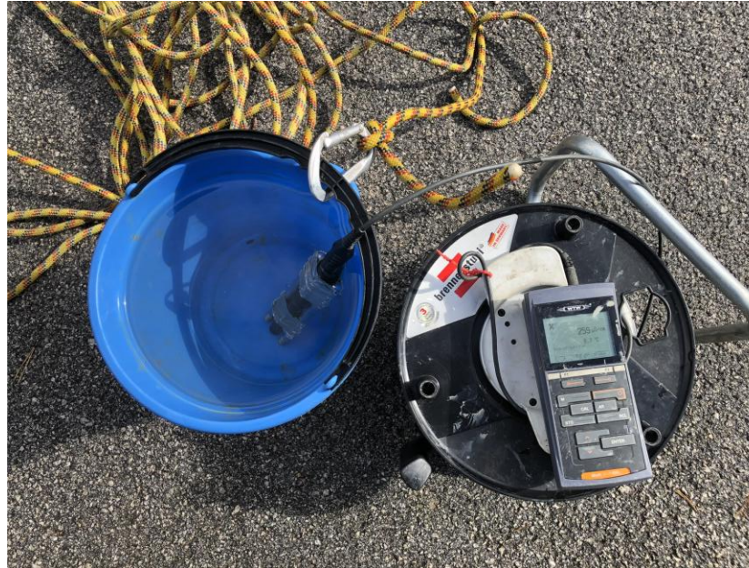
Meritve prevodnosti in temperature vode za ugotavljanje njenega izvora
